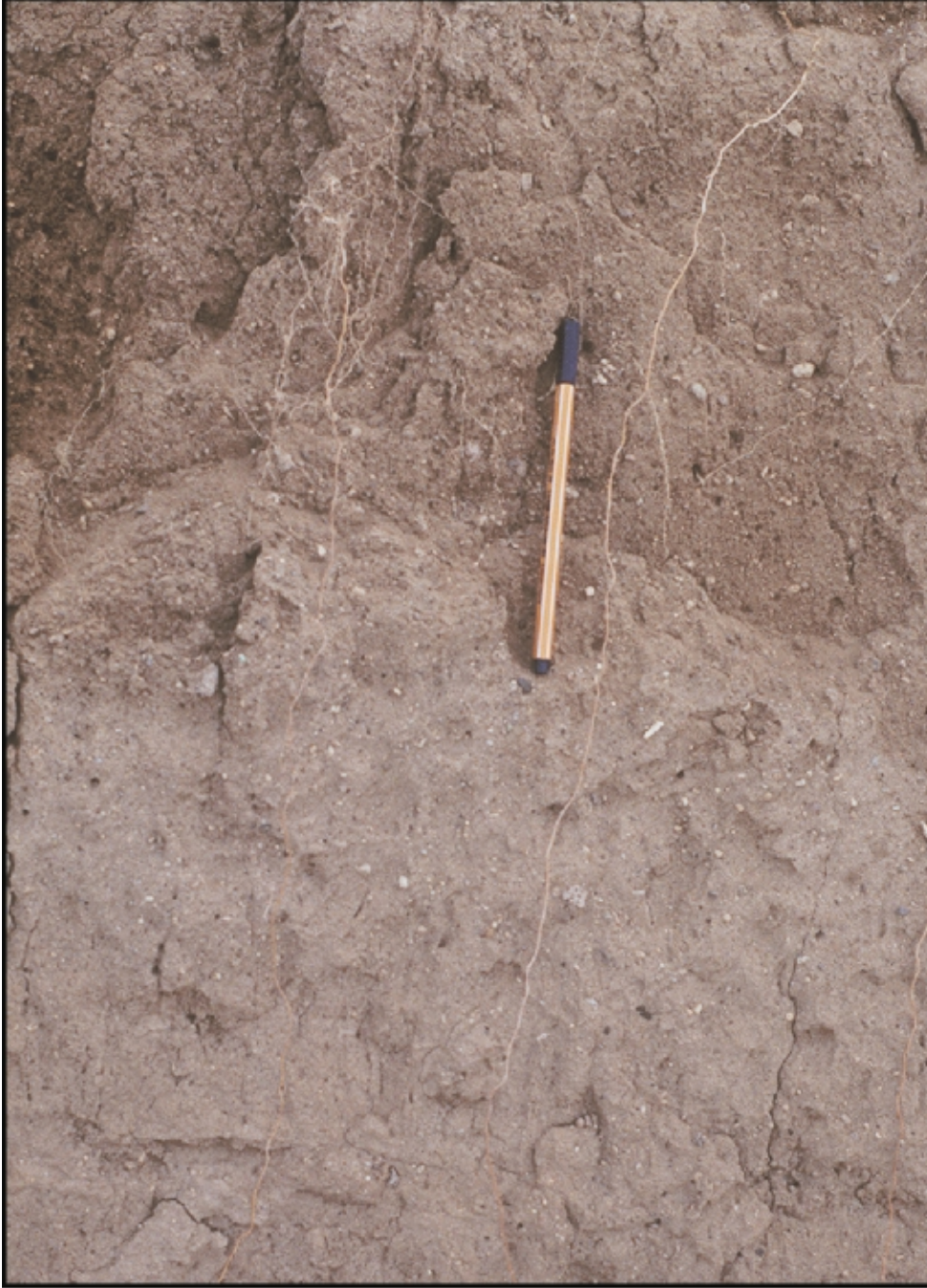
Şekil 6. Akşehir-Afyon Grabeni dolgusunu ve yerleşim birimlerinin zeminini oluşturan pekişmemiş sedimanlar. (Yer Çobanlar ilçesi kuzey-batısı)
