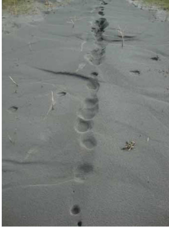
Şekil 2.13. Sıvılaşma örneği (Topaktaş Köyü – Karasu kıyısı).
