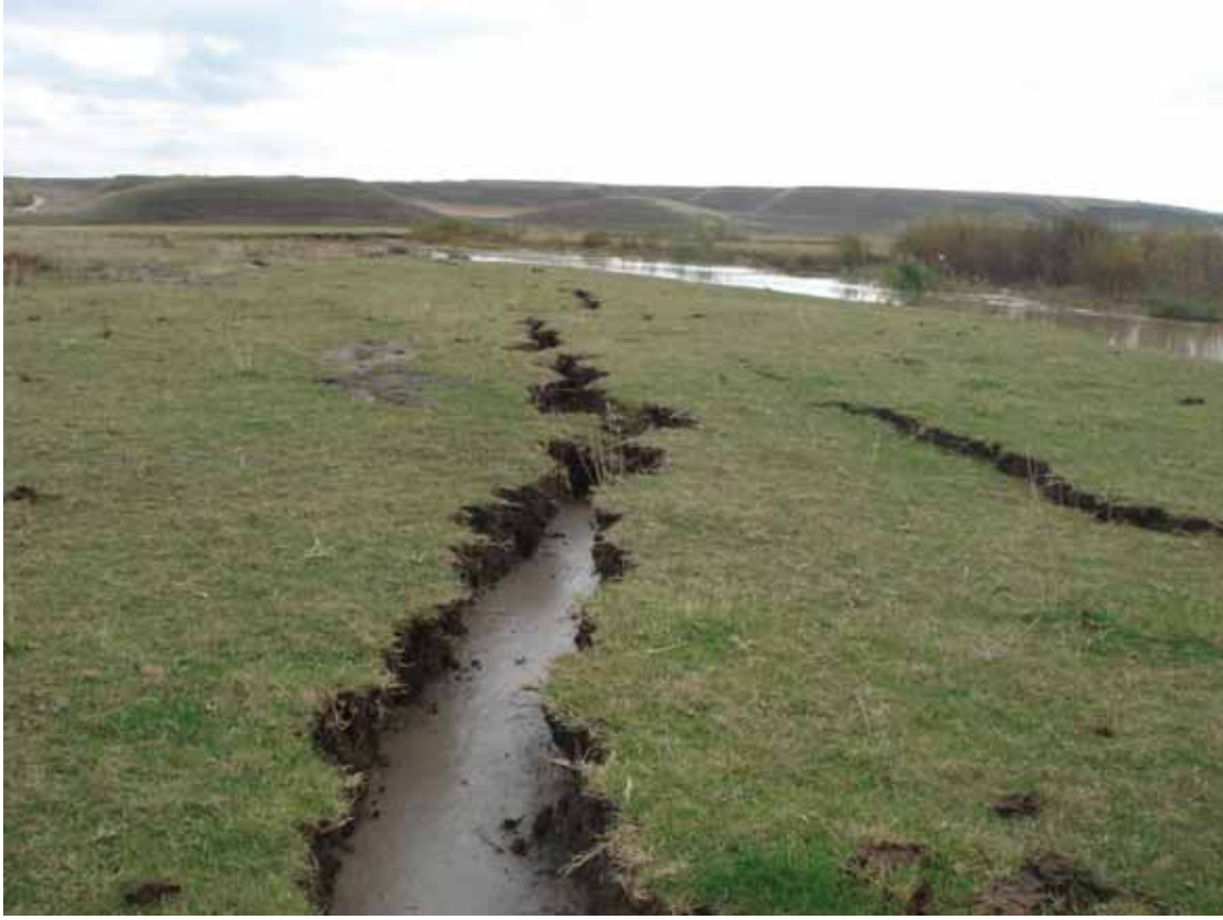
Şekil 2.16. Sıvılaşma-yatay deformasyona bir başka örnek (Topaktaş Köyü-Karasu Kıyısı).
