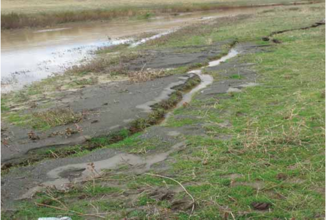
řekil 2.15. Sıvılařma ve yatay deformasyon örneđi (Topaktař Köyü-Karasu Kıyısı).
